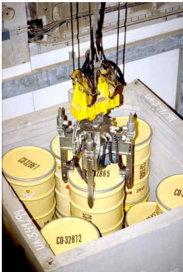
LLENADO DE UN CONTENEDOR CON BULTOS
