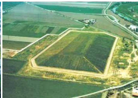
Antes y Después del Desmantelamiento de las Instalaciones de la FUA y el Acondicionamiento Definitivo de sus Diques de Estériles
